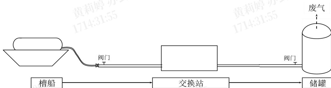
图 2.2-1 卸船工艺流程图
